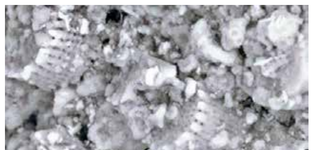
Mikroskopische Aufnahme der Oberfläche von StarTop mit seinen korallenartigen Füllkörpern.
