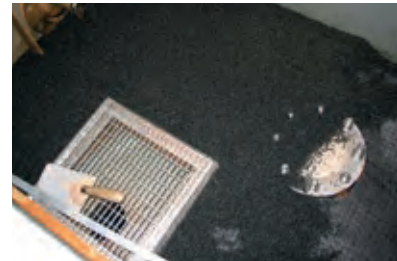
Prüfungsaufbau mit Dränagematte und Splittbett vor dem Aufsatz
