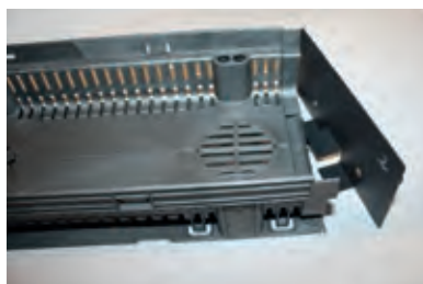
Ansetzen der Stirnwand
