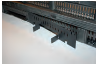
Aufstecken des Anschlusselementes auf die Zapfen
