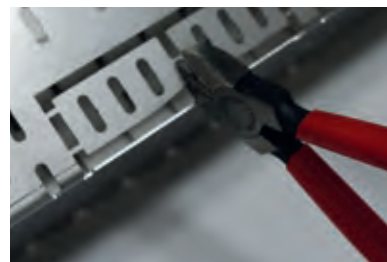
Öffnen des Stichkanalanschlusses
