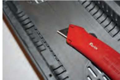
Durchtrennung der Rippen von oben, nach außen drücken der Rippen
