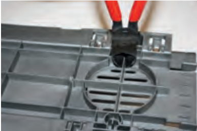
Durchtrennen der vier Stege von unten
