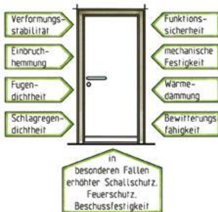
Abbildung: Technische Funktionen der Haustür
