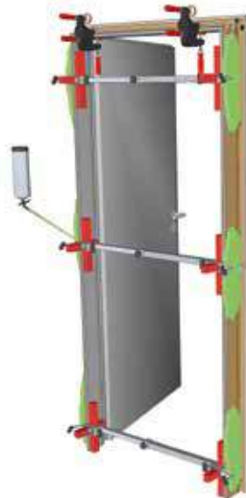
Abbildung: Position der Spreizen
