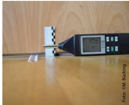
Abbildung: Bodendichtungen die nicht fachgerecht eingestellt sind, wirken sich erheblich auf die Schalldämmung des Elements aus.
