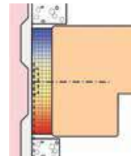
Multifunktionsdichtungsband auf Glatzstrich
