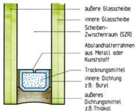
Abbildung: Aufbau einer Mehrscheiben-Isolierglasscheibe
