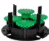
Stelzlager, Vollstück höhenverstellbar von 35-50 mm, ergibt 2 mm breite Fugen. Höhe der Fugenstege kann individuell z.B. mit einem Seitenschneider gekürzt werden. Rand- und Eckstücke können herausgebrochen, bzw. geschnitten werden. (Nur für Granitkeramik Platten geeignet)
