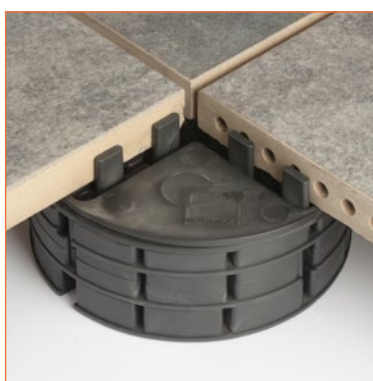
Maxi-Lager 20/4x10 (2fach) und Maxi-Lager 10/4x20 mit 2 Maxi-Ausgleichsscheiben gestapelt und verlegt unter einer Keramikplatte
