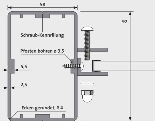
Beim Aluminium-Pfostensystem TEJEFLEX werden die Sichtschutzelemente mit Hilfe von Klemmschienen zwischen den Pfosten montiert. Für Holzelemente sind spezielle Aluminium-Winkel verfügbar.
