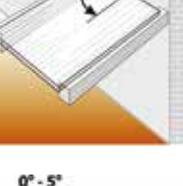
**DACHNEIGUNG** siehe Skizze 1, Seite 42 Die Dachneigung muss mindestens 5° = 9 cm/m betragen, damit die Dichtigkeit der Profilsysteme gewährleistet ist und kein Regenwasser im Stirnseitenbereich eindringen kann – Gefahr von Algenbildung. Die Platten sind im Traufenbereich durch Profilabschlusswinkel gegen Abrutschen zu sichern. Stegrichtung ist immer in Wasserlaufrichtung.
